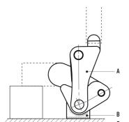
Anleitung Schweissposition : Teil "A" wird an Teil "B" geschweisst. Teil "B" wird an "C" geschweisst
